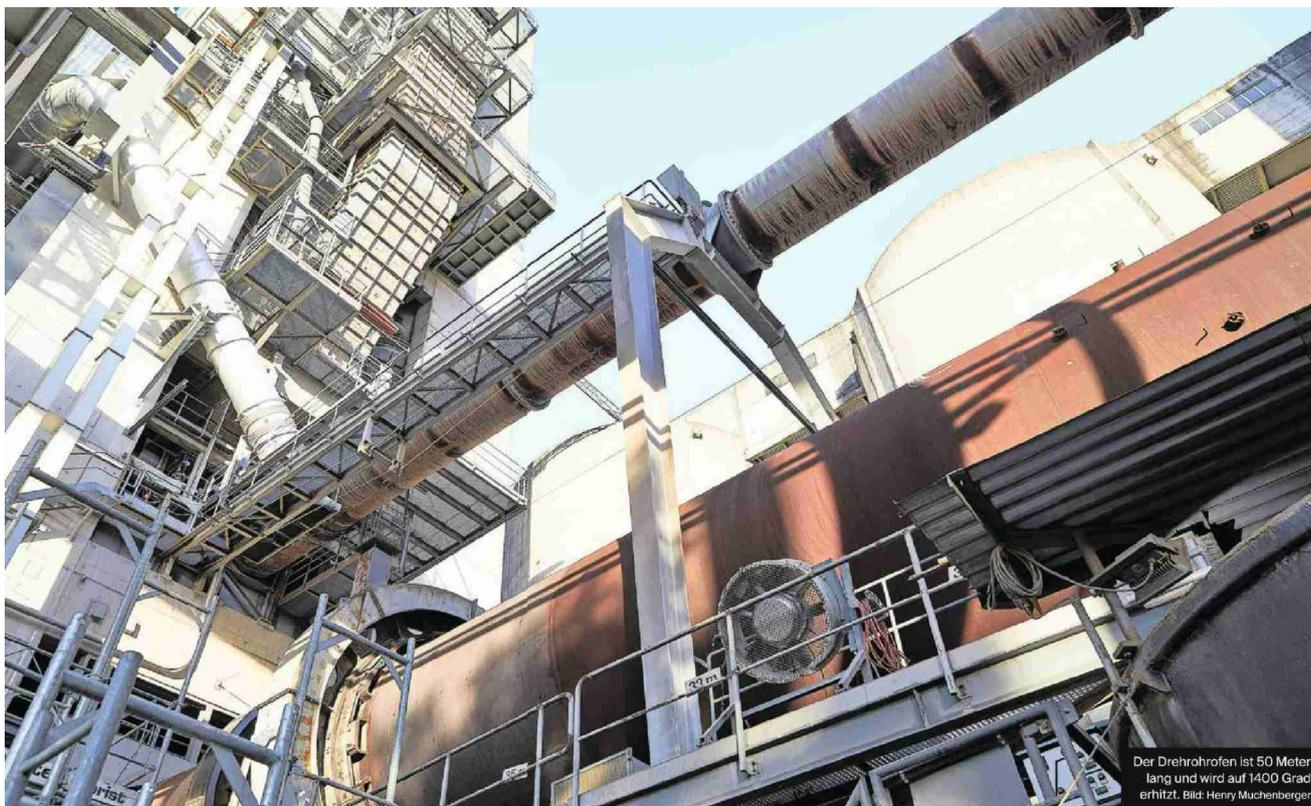
Der Drehrohrföfen ist 50 Meter lang und wird auf 1400 Grad erhitzt. Bild: Henry Muchenberger
